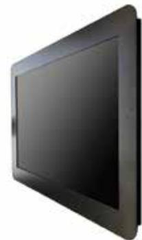
Cet écran tactile INSERT s'adapte parfaitement à vos exigences puisqu'il est conçu pour une utilisation sur mesure horizontale (encastrable dans un mobilier) ou verticale (avec sa fixation murale). Disponible en 42", 47" ou 55" avec 6, 12 ou 32 points de touche.
